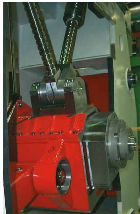
AM-Teleskop-Kugelgewindetriebe für unterschiedliche Ausrichtpositionen
