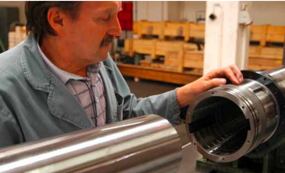
Bohrspindelsatz mit Hohlspindel über die gesamte Länge innen geschliffen und mit Bohrspindel auf Schmierfilmstärke gepaart
