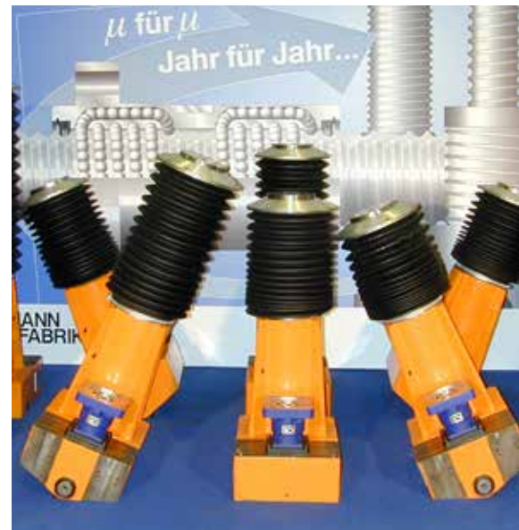
AM-Teleskop-Kugelgewindetriebe für unterschiedliche Ausrichtpositionen
